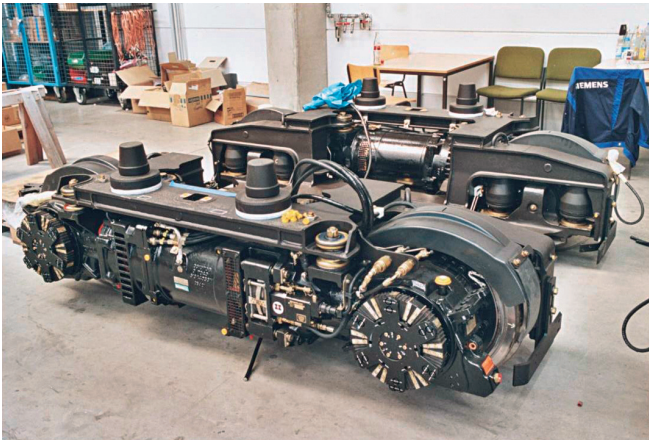
Figure 14 – Bogie moteur du « Combino » de Siemens avec les moteurs de traction longitudinaux entraînant deux roues indépendantes d'une même file de rails (photo GM)
