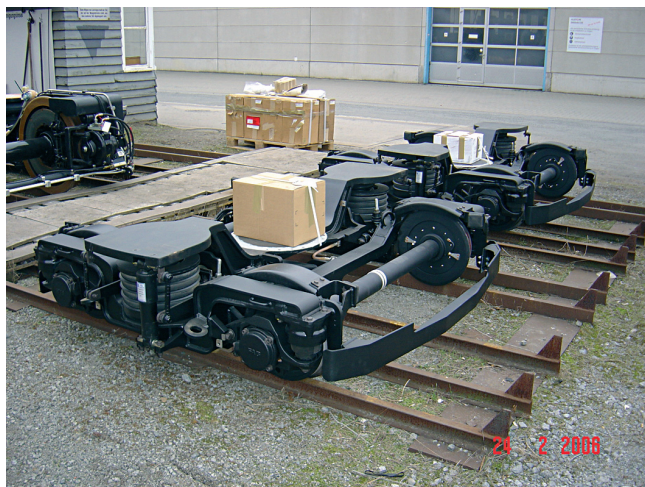
Figure 7 – Strasbourg : bogie porteur d'extrémité « Magdebourg » construit par Alstom LHB (photo H. Hondius)
