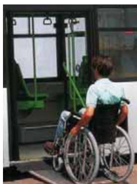
L'accès au véhicule sera facilité grâce à un plancher bas, et l'installation d'un palette rétractable.
