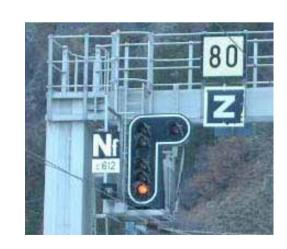
\*Les indicateurs de directions: Afin d'être renseigné sur l'itinéraire tracé par l'aiguilleur, des indicateurs de direction sont montés avec le signal de protection de l'aiguille et présente un feu blanc pour la première direction géographique à partir de la gauche, 2 feux pour la deuxième direction géographique à partir de la gauche, 3 feux pour la 3ème direction, etc...
