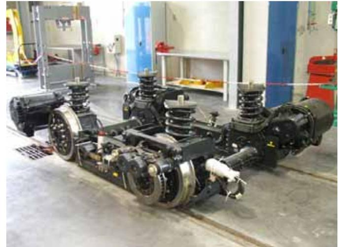
*Vue d'un bogie de rechange, entreposé à Meyzieu. En cas de réparation lourde sur le bogie d'une rame, celui-ci est immédiatement remplacé par un neuf pour permettre la remise rapide en circulation de la rame avariée. Ensuite, les équipes de maintenance peuvent s'affairer sur leur réparation, sans impacter l'exploitation de la ligne en immobilisant une rame.*
