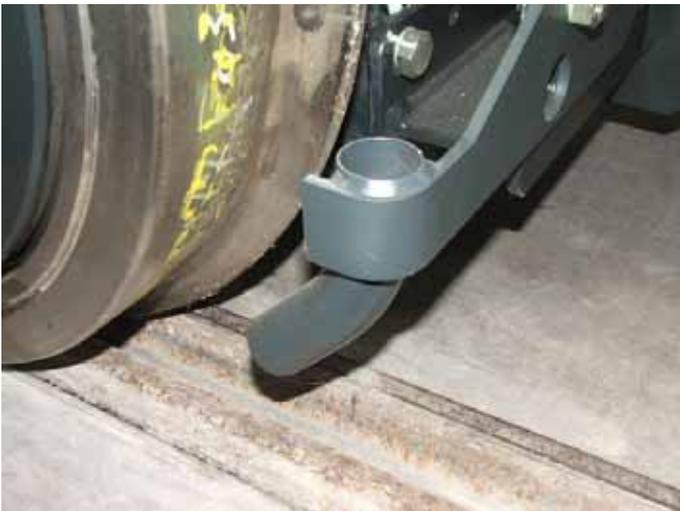
Gros plan sur une des roues du boggie : devant la roue à droite, on aperçoit l'emplacement du tuyau qui déverse le sable en cas de besoin.
