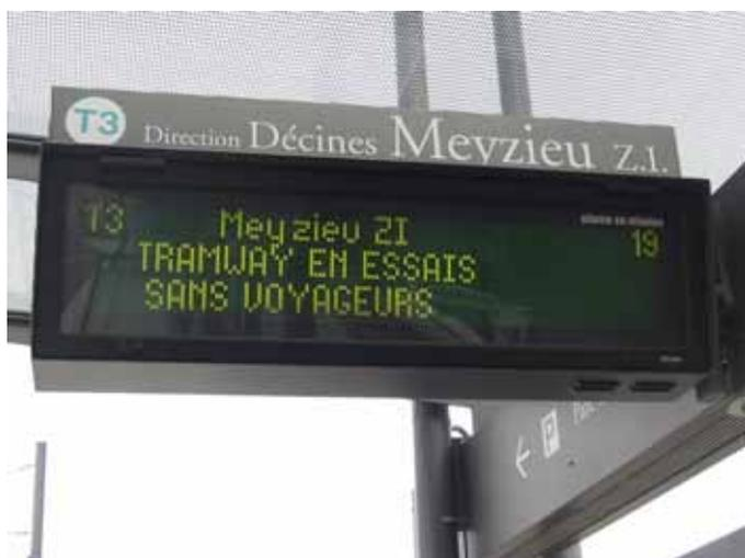
Les afficheurs en station sont de la même marque que ceux déjà installés sur les lignes T1, T2 : des Lumiplan. Il s'agit d'un modèle différent aux matrices de caractères plus fines, et une vitre de façade en 3 volets. Ils s'intègrent dans la station comme nous avons l'habitude de le voir jusqu'à présent.
