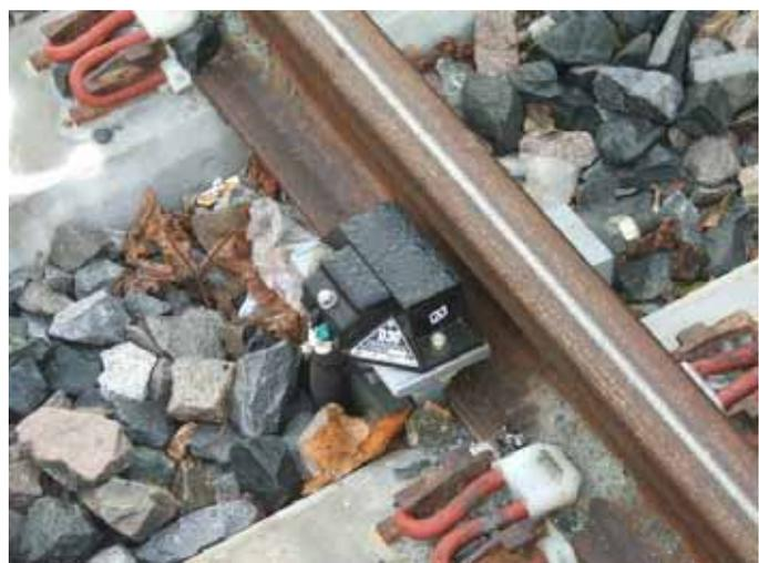
*Ci-dessus, ce petit capteur magnétique permet d'acquiescer le passage à niveau. L'acquiescement consiste à donner l'information au passage à niveau que la rame a bien terminé le franchissement de l'intersection et que les barrières peuvent se relever.*
