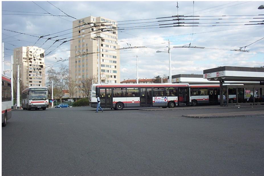
À Laurent Bonnevey, impressionnante ramification de lignes aériennes pour gérer l'arrivée des lignes 1 et 11. La ligne 1 se divise à nouveau en 2 pour permettre le dépassement de 2 véhicules ou la présence simultanée de plusieurs véhicules de fronts en station.
