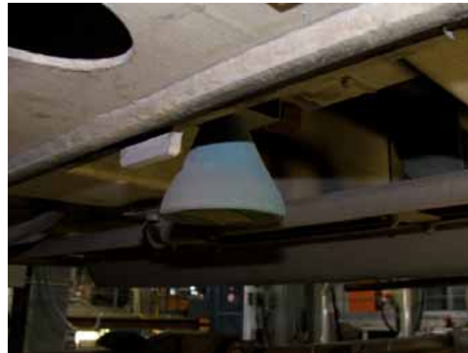
Sous chaque extrémité de la rame, voici la balise émettrice qui permet de déclencher la priorité aux feux du tramway dans les carrefours.
