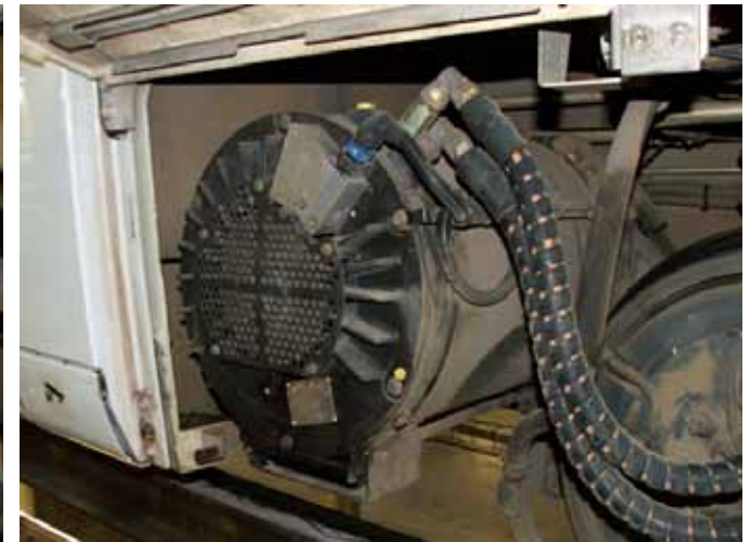
Un moteur électrique. La rame en a 4 en tout
