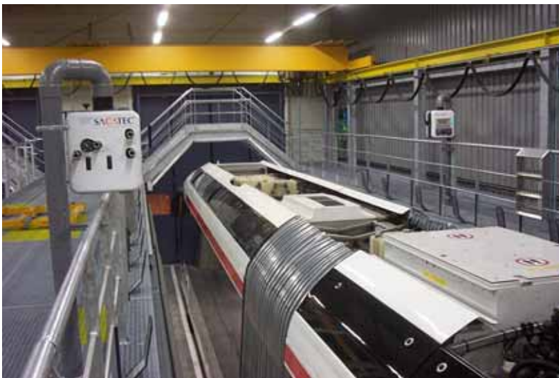
Pour les Cristalis, une nacelle spéciale a été construite pour accéder aux composants électriques situés sur le toit des véhicules.
